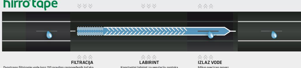
Poseban sustav oblikovanja trake s konstantnim labirintom daje vrhunske performanse i ujednačenost emitera. Dizajn konstantnog labirinta pruža visok stupanj otpornosti na začepljenja i dužu upotrebu sustava, a samim tim racionalnije iskorišćavanje vode.
