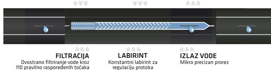
Poseban sustav oblikovanja trake s konstantnim labirintom daje vrhunske performanse i ujednačenost emitera. Dizajn konstantnog labirinta pruža visok stupanj otpornosti na začepljenja i dužu upotrebu sustava, a samim tim racionalnije iskorištavanje vode.
