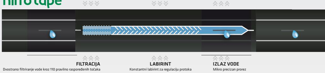
Poseban sustav oblikovanja trake s konstantnim labirintom daje vrhunske performanse i ujednačenost emitera. Dizajn konstantnog labirinta pruža visok stupanj otpornosti na začepljenja i dužu upotrebu sustava, a samim tim racionalnije iskorištavanje vode.
